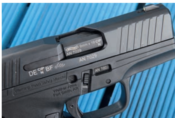
Der beidseitige Zerlegehebel sitzt hinter der Seriennummer im Griffstück. Hingucker: Das schräge Auswurffenster.
