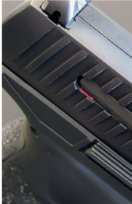
Unauffällig ist der kleine rote Strich der Ladezustandsanzeige, der durch geringes Einkippen der Ausziehkralle im geladenen Zustand im Bereich der rechten hinteren Griffrielen des Schlittens sichtbar wird.
