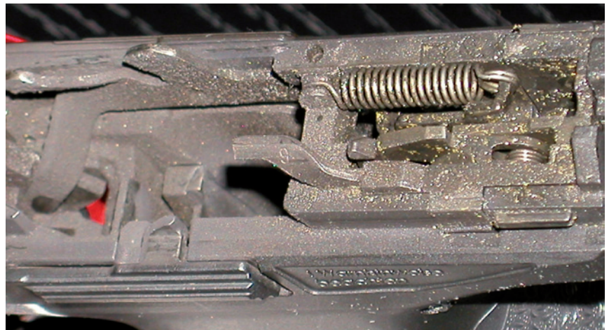
Der Belastungstest und über 5000 Schussabgaben ohne Reinigung hinterließen ihre Spuren. Besonders im Innern des Griffstückes waren alle Bauteile mit einer Schicht aus Pulverrückständen überzogen. Um auch den erheblichen Messingabrieb der Hülsen deutlicher sichtbar zu machen, wurden Belichtungsänderungen vorgenommen.
