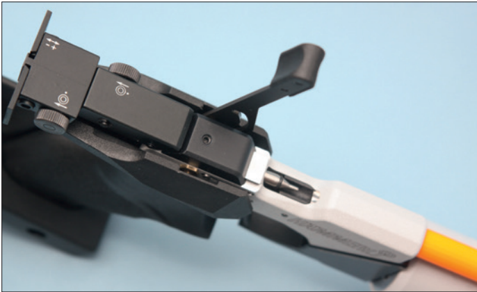
Deutlich zu sehen bei Visierung und System die Symbole der Einstellung und die kurze Laderinne mit Diabolozuführung per Stößel.
