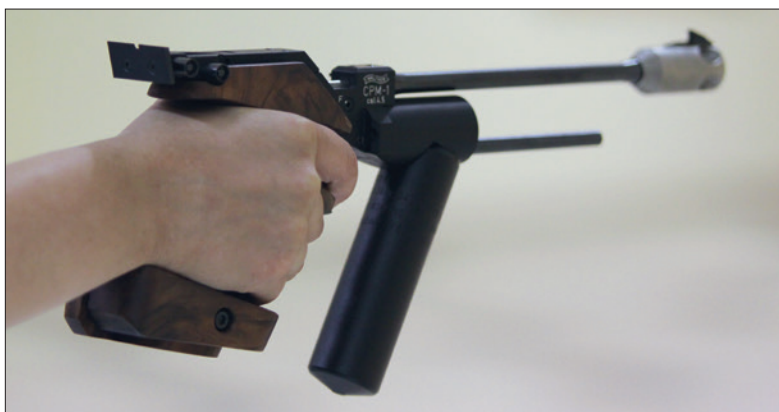
Der Urahn in Sachen Design: Die Walther CPM 1 – noch mit CO 2 als Antriebsmittel.
