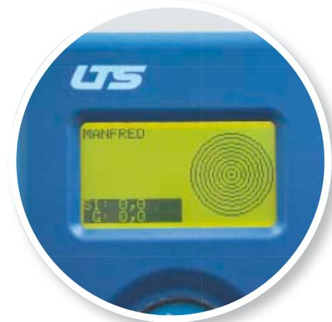
das Ziel mit einem Schussgeräusch, das Display zeigt diese grafisch und numerisch an. Auch lässt sich das Zentraldisplay über eine serielle Schnittstelle an einen PC anschließen, wofür aber ein Kabel und Software notwendig sind.
